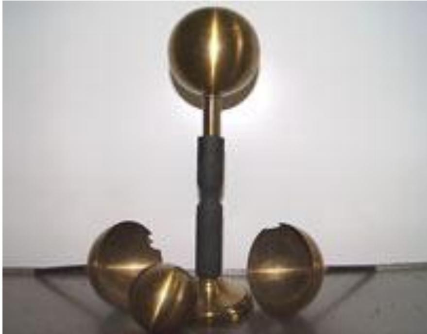
Consta de una esfera de latón sobre un pie de latón sujeto con un soporte aislante como se indica en la figura debería ir acompañada de dos semiesferas del mismo material con un mango aislante Se puede comprobar que si se carga la esfera y se aproximan las dos semiesferas estas últimas quedan con la misma carga de la esfera y la esfera queda descargada. p. 404 de Física de Ganot.
