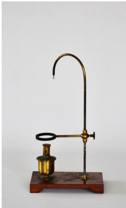
Este aparato se encuentra compuesto por una esfera metálica suspendida de un soporte. En el mismo soporte se encuentra sujeto un anillo por el cual la esfera, por sus dimensiones a temperatura ambiente, puede pasar sin dificultad. Por otro lado, por debajo de la esfera se encuentra una lámpara de alcohol. Debido al calor
