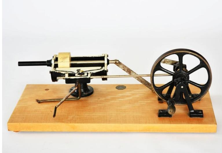
Sirve para comprobar el funcionamiento del cilindro y cómo el movimiento alternativo del pistón gracias a la biela y a la manivela se convierte en un movimiento de rotación. Pegada al cilindro tiene una caja de distribución, en la que se mueve una pieza llamada corredera, que es la que hace que el vapor entre una vez por una cara del émbolo y otra vez por la otra moviendo el embolo de un lado para otro, llamado por eso movimiento alternativo.
