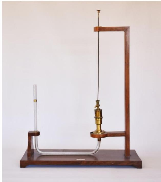
Instrumento utilizado para demostrar que la presión sobre el fondo de un recipiente ( $P$ ) depende solo de la altura y de la densidad del líquido que contiene ( $P=g \cdot h \cdot d$ ). ( $g$ =gravedad,  $h$ =altura,  $d$ = densidad).
