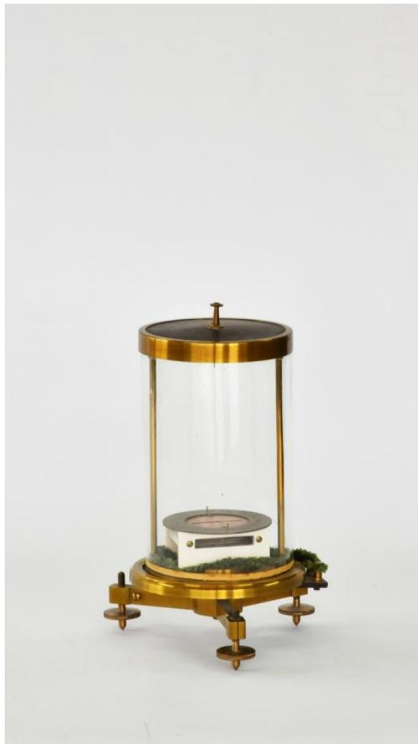
En el galvanómetro de Nobili una doble aguja imantada, en forma de "H" con los polos opuestos (astática), una de las agujas está dentro y la otra fuera de una bobina fija. La "H" es libre de moverse, respondiendo a la corriente a medir que circula por la bobina.
