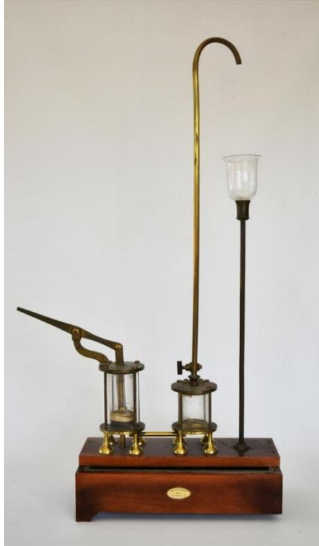
Bomba que saca el agua de profundidad por aspiración y luego la impele por presión del émbolo. Su función es elevar líquidos. Es también llamada bomba mixta, porque es aspirante e impelente.
