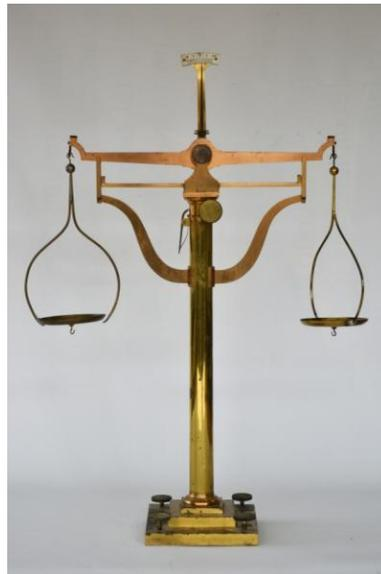
Debido a su forma y estructura se pueden colgar objetos de los platillos para sumergirlos en un líquido.
