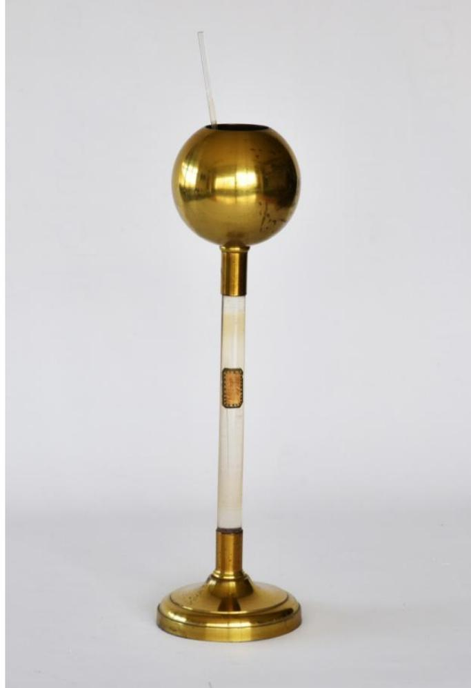
Se trata de un aparato que sirve para demostrar que las cargas eléctricas se colocan en la superficie y se le conoce como semiesferas de Biot.
