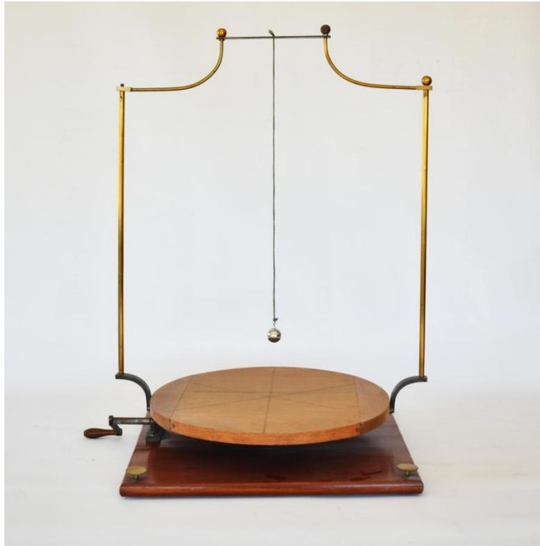
Un péndulo de Foucault es un péndulo que puede oscilar libremente en cualquier plano vertical y capaz de oscilar durante mucho tiempo (horas). Se utiliza para demostrar la rotación de la Tierra. Se llama así en honor de su inventor, León Foucault. Está montado sobre una plataforma que se hace girar con la manivela. Permite simular lo que sucede con un péndulo por el movimiento de rotación de la Tierra.
