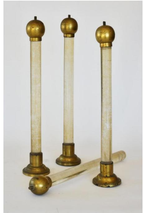
El aparato de la siguiente fotografía servía para estudiar el efecto de una descarga sobre un animal o un objeto que se colocaba en la plataforma conectando con una pila o un generador eléctrico. Es similar al que aparece descrito en Ganot , p.466.
