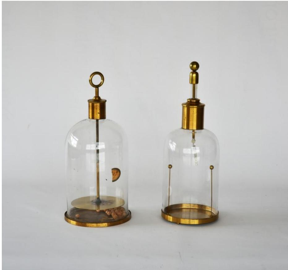
El electroscopio es un instrumento que se utiliza para saber si un cuerpo está cargado eléctricamente.
