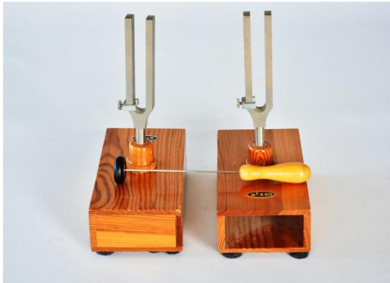
Un diapasón es un dispositivo metálico (generalmente de acero) con forma de horquilla. Se utiliza principalmente como referencia para afinar instrumentos musicales y para estudiar los fenómenos relacionados con vibraciones, ondas, resonancia...
