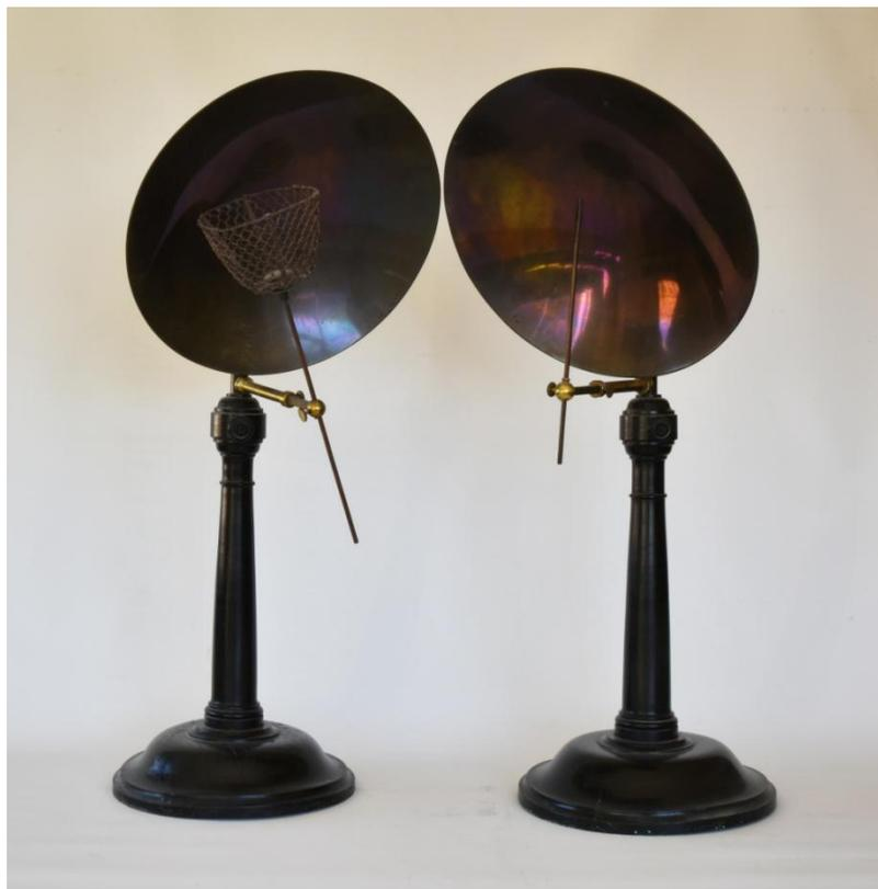
Se trata de dos espejos que se pueden utilizar para demostrar la reflexión de las ondas y la concentración de las mismas en el foco. Sirven para trabajar con ondas sonoras, caloríficas o luminosas.
