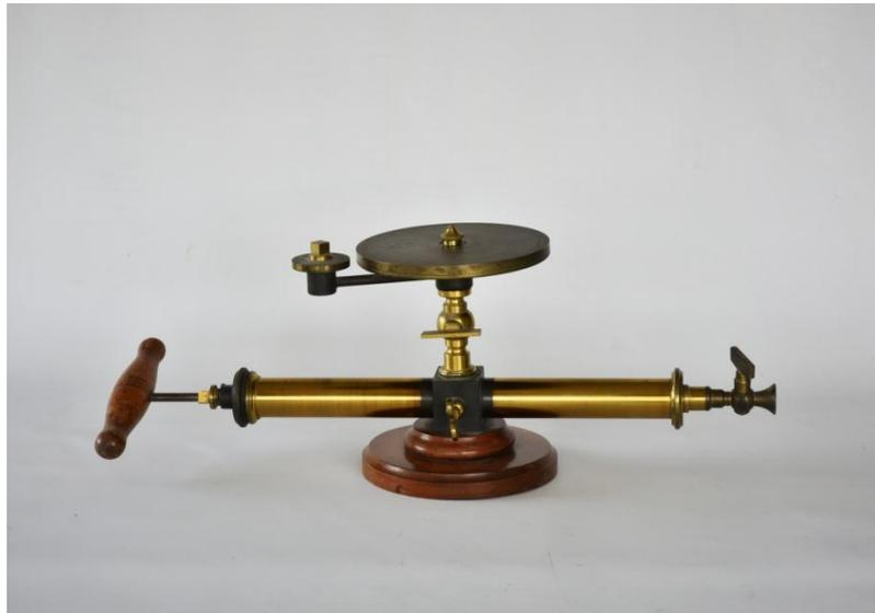
*Bomba de vacío o compresor (según se monte)*
